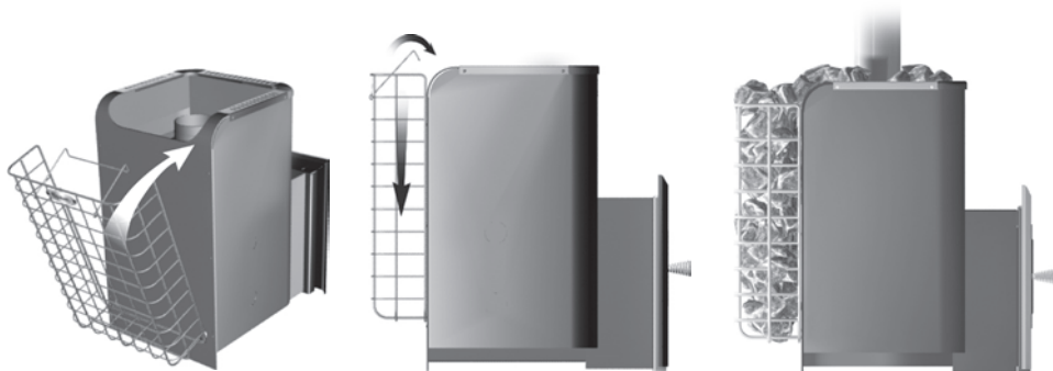
Рисунок -8. Установка сетки-каменки на печь.
